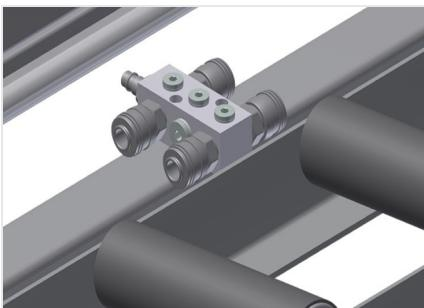
**Raccord d'air comprimé quadruple**
