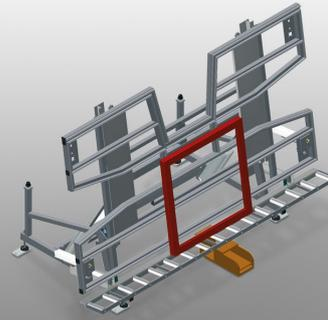
Table d'assemblage pour le montage vertical et horizontal
