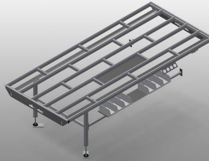
Table de travail modulaire pour une ligne de fabrication (module de base)
