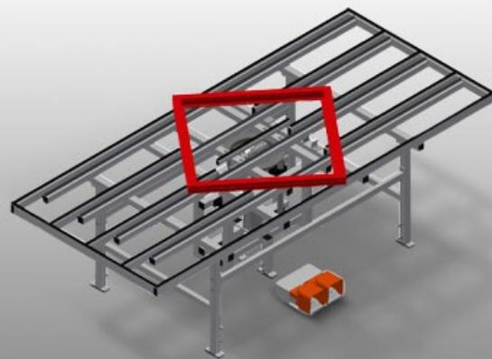
Table de levage pivotante pour le montage et la mise en place du joint
