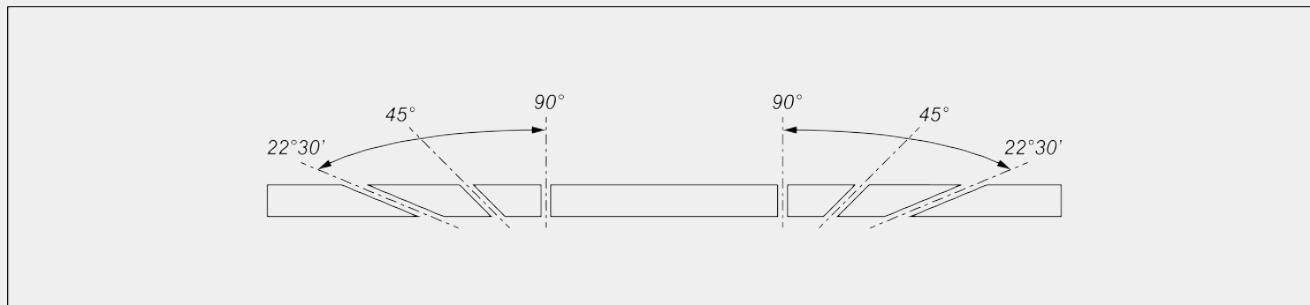
Réglage mécanique des angles intermédiaires
