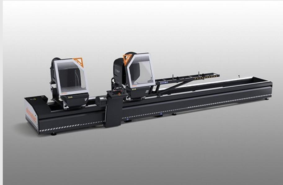
Tronçonneuse à double tête électronique, mouvement automatique de la tête mobile grâce à un moteur brushless à commande numérique par calculateur. Inclinaison pneumatique des unités de coupe de 90° jusqu'à 22°30' (externe) dans deux positions fixes ou avec système mécanique optionnel de réglage des angles intermédiaires. Avance oléopneumatique de la lame.
