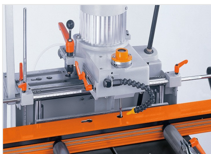
Fraiseuse à copier mono- broche AS 70/44
