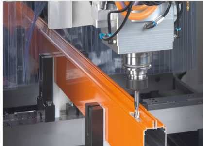
SBZ 140 Centro de mecanizado de barras
