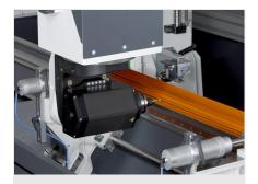
Ajuste angular del eje A
