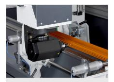
**Ajuste angular del eje A**Ajuste angular continuo de -120° a +120°
