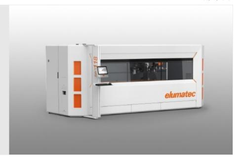
Cómodo centro de mecanizado de perfiles de 3 ejes con opción de mecanizado de 5 lados, y todo ello en un espacio mínimo:
