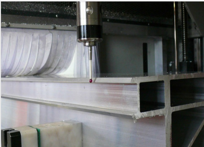
Medición durante el proceso de trabajo con la sonda inalámbrica
