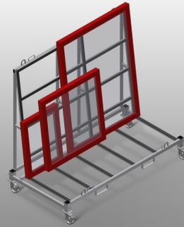
Carro para piezas terminadas para el transporte interno de los elementos de ventana
