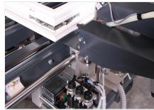
Unidad de atornillado Unidad atornilladora móvil con ajuste neumático de altura
