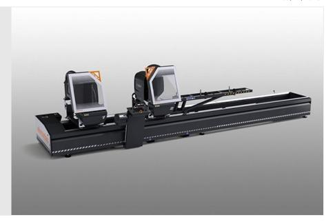
Tronzadora de doble cabezal electrónica con movimiento automático del cabezal móvil mediante motor brushless accionado por un control numérico. Inclinación neumática de los cabezales de corte de 90° hasta 22°30′ (externa) en dos posiciones fijas o con sistema opcional mecánico de regulación de los ángulos intermedios. Avance disco oleoneumático.
