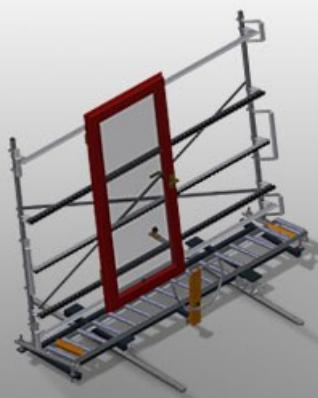
Rollenbahn vertikal für Transport von Fensterelementen
