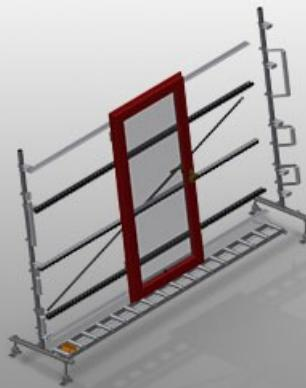
Rollenbahn vertikal für Transport und Lagerung von Fensterelementen
