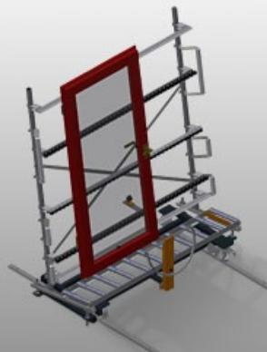
Rollenbahn vertikal für den Transport von Fensterelementen
