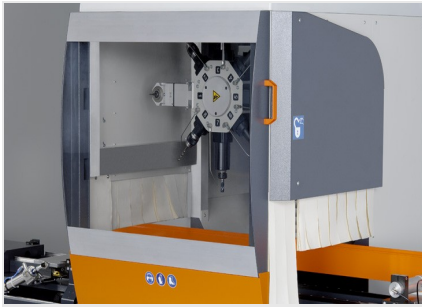
a- Stabbearbeitungszentrum SBZ 131 eluCam
