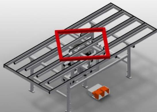
Hebe-Drehtisch für Montage und Dichtungseinzug
