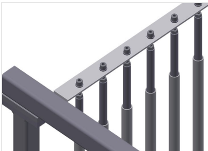
Fachteiler mit Kunststoffschutz
