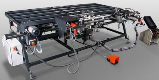
Flügelanschlagzentrum für die Beschlagmontage an Kunststoff- und Aluminium-Fensterflügeln
