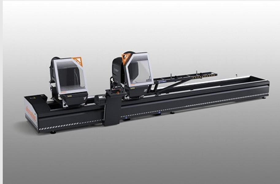
Doppelgehrungssäge mit automatischer Verfahrbewegung des beweglichen Sägeaggregats über Brushless-Motor und CNC gesteuert. Pneumatisch gesteuerte Neigung der Sägeaggregate von 90° auf 22°30' (nach außen) auf zwei festen Positionen oder mit einem optionalen mechanischen Einstellsystem der Zwischenwinkel. Hydropneumatischer Sägeblattvorschub.
