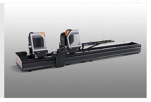
Doppelgehrungssäge mit automatischer Verfahrbewegung des beweglichen Sägeaggregats über Brushless-Motor und CNC gesteuert. Pneumatisch gesteuerte Neigung der Sägeaggregate von 90° auf 22°30′ (nach außen) auf zwei festen Positionen oder mit einem optionalen mechanischem Einstellsystem der Zwischenwinkel. Hydropneumatischer Sägeblattvorschub.
