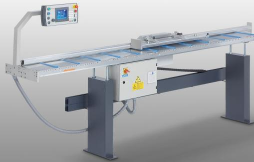
Anschlag- und Mess-System mit automatischer Schnittlängenverstellung und Positioniersteuerung E 355
