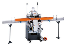
3vřetenová kopírovací fréza KF 178/10
