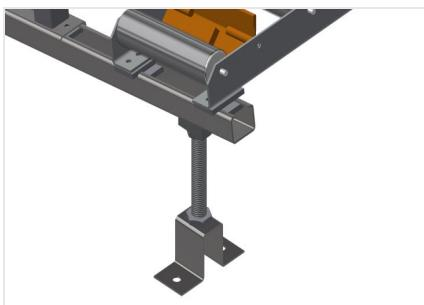
**Réglage en hauteur du convoyeur à rouleaux**
