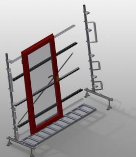
Convoyeur à rouleaux vertical pour le transport et le stockage des éléments de fenêtre
