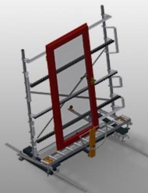
Convoyeur à rouleaux vertical pour le transport des éléments de fenêtre
