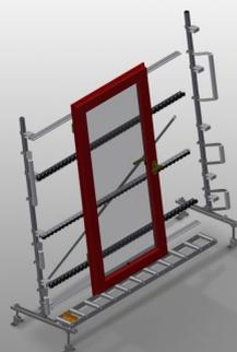
Convoyeur à rouleaux vertical pour le transport et le stockage des éléments de fenêtre
