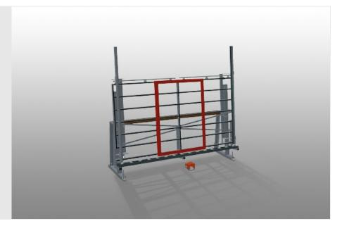
Unité de contrôle et de vitrage pour le vitrage et le contrôle final
