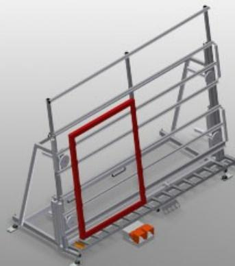
Support d'assemblage pour montage vertical
