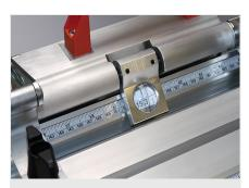
Système de butée et de mesure MMS 100
