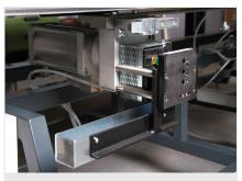
Poinçon de ferrures Poinçon de ferrures avec des butées pour le siège de poignée central et constant. Poinçon de ferrures à outil de coupe ouvert
