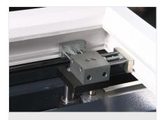
**Bloc de butée** 2 blocs de butée pour 2 largeurs de vantail
