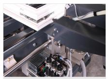
Unités de vissage Unité de vissage mobile à réglage pneumatique de la hauteur.
