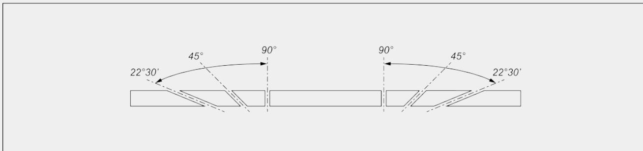
Réglage mécanique des angles intermédiaires
