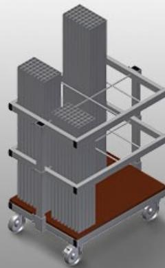
Chariot de transport et de mise à disposition avec triage des renforts métalliques
