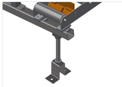
**Ajuste de altura del transfer de rodillos**
