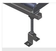
Ajuste de altura del transfer de rodillos
