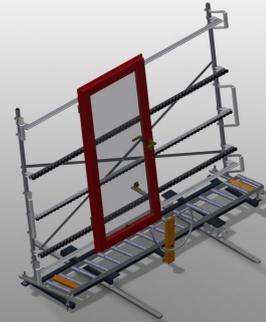
Transfer de rodillos vertical para el transporte de elementos de ventanas
