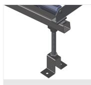
Ajuste de altura del transfer de rodillos
