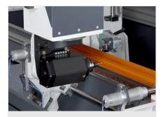
Ajuste angular del eje A
