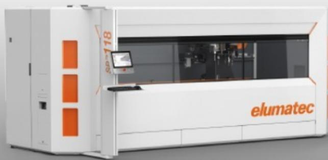
**Cómodo centro de mecanizado de perfiles de 3 ejes con opción de mecanizado de 5 lados, y todo ello en un espacio mínimo:**
