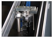
**Topes abatibles**Dos topes abatibles neumáticamente con revólver para construcciones de marco con hasta cuatro profundidades diferentes
