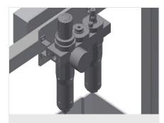
**Unidad de mantenimiento**Unidad de mantenimiento para herramientas neumáticas
