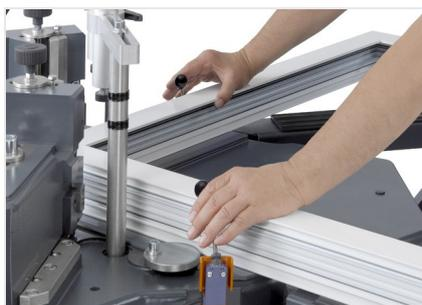
**Ensambladora de esquinas EP 124/20**
