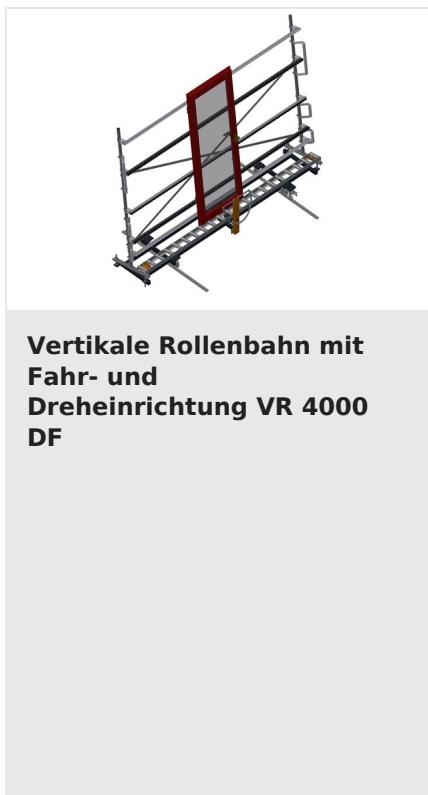
**Vertikale Rollenbahn mit Fahr- und Dreheinrichtung VR 4000 DF**
