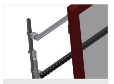
**Anlage**Rückseitige Anlage mit KunststoffGleitleisten oben und unten
