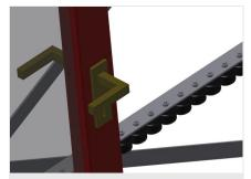
**Röllchenbahn**Drei Röllchenbahnen mit Gummi-Rollen,Durchmesser 50 mm
