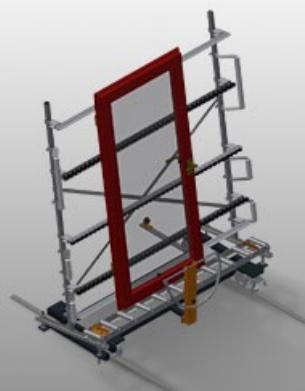
Rollenbahn vertikal für den Transport von Fensterelementen
