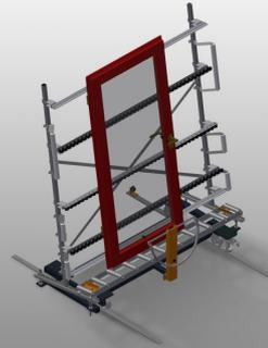
Rollenbahn vertikal für den Transport von Fensterelementen
