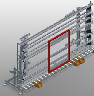
Kontroll- und Verglasungseinheit für das Verglasen und die Endkontrolle in Einzel- und Serienfließfertigung
