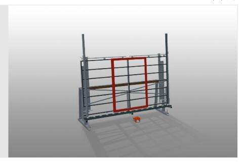
Kontroll- und Verglasungseinheit für das Verglasen und die Endkontrolle
