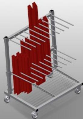
Profilwagen für die senkrechte Lagerung und den Transport von Profilen
